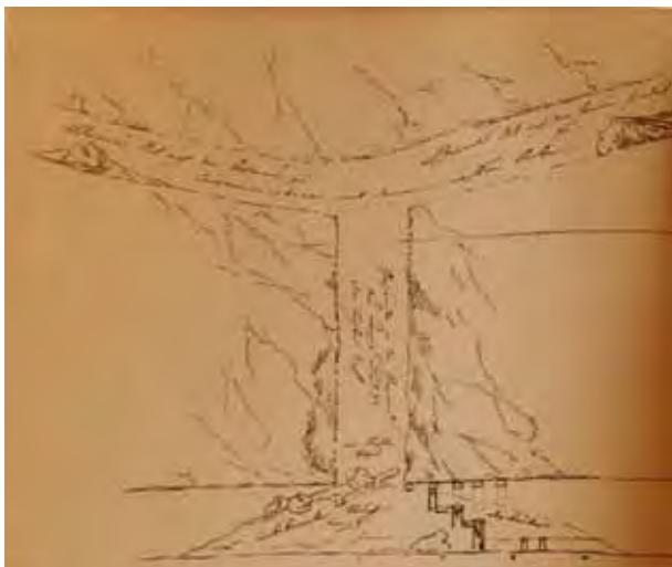
Foto 2. Net als Humboldt (zie foto 1) hield Goethe zich bezig met het onderzoek naar ondergrondse instabiliteit van mijnen zoals hier zijn persoonlijke 2d schets van de open drainage steengang genoemd de Martinrodaer Stollen (beneden) die verstopt raakte (links) door de breuk van een neerhouw (Wagenbreth 1983).
