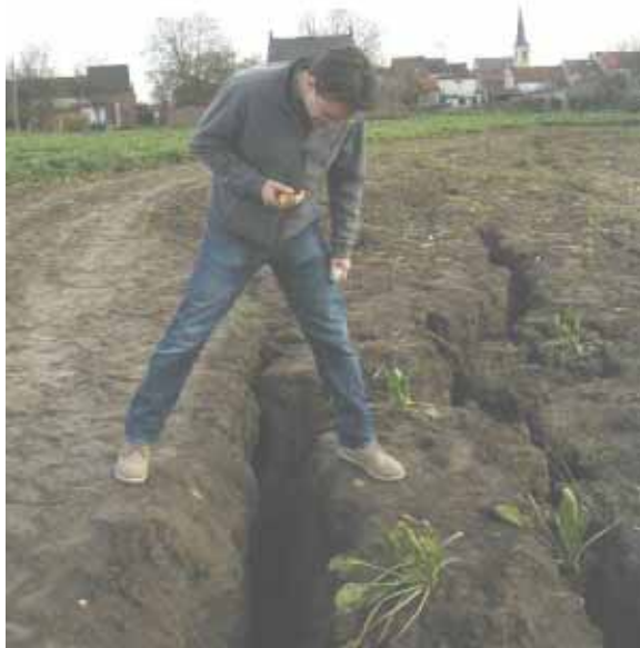
Figuur 2. Trekscheur in de grond (ca 2 m diep) als gevolg van de instorting van 26 september 2002 nabij het dorpje Zussen (België)
