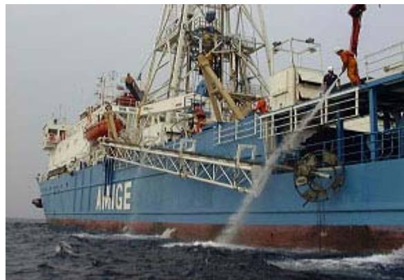
Figuur 4. M/V Bavenit met STACOR op de Deployment Stinger
