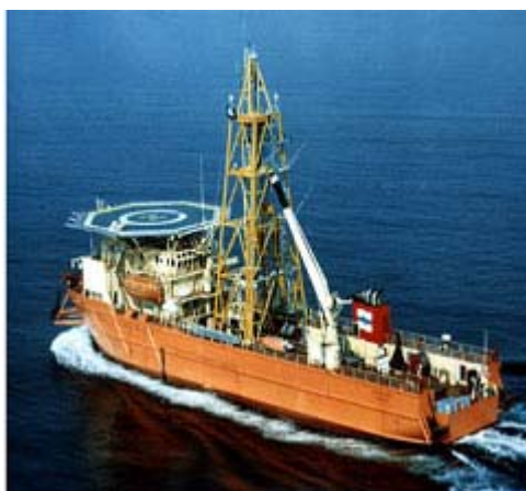
Figuur 1. M/V Bucentaur, boorschip uitgerust voor diepwater onderzoek
