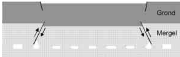
Fig. 3. Veel voorkomende geometrie van een grootschalige instorting.
