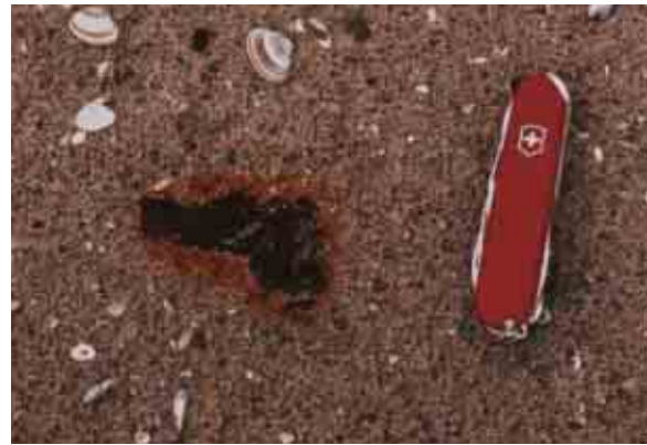
Figuur 4: Geoxideerd veen met pyriet
